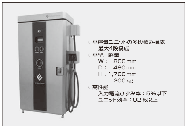
図10 25 kW 急速充電器
